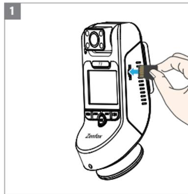
1. 本機のスロットにmicroSDカードを挿入します。
